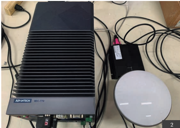
1. 系統架構 2. 定位系統基站
