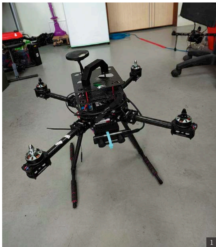
本計畫所用軸距 550mm 之四軸多旋翼無人飛行載具
