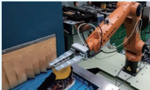
▲ 將PLC和KUKA機械手臂的整合，完成鞋底壓合和鞋楦的夾取與放置
